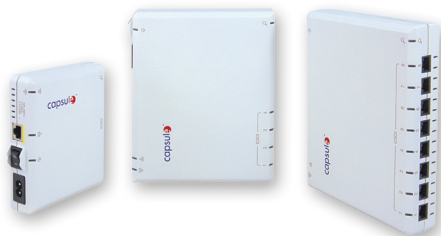
[SmartLinX Axon]: Serie bietet Versionen mit 1, 4, und 8 Ports
